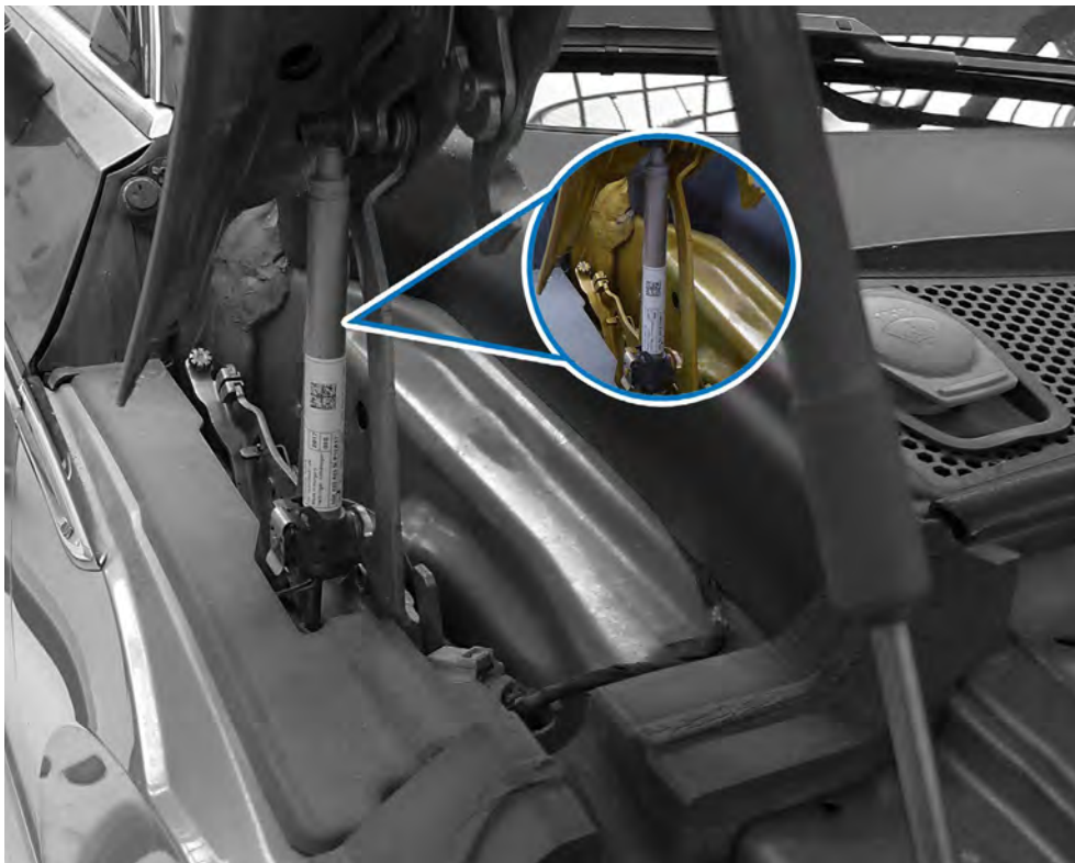
Beispiel aktive Haube mit pyrotechnischem Aktuator.
