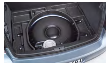
Autogas- bzw. Flüssiggastank im Gepäckraum-boden
