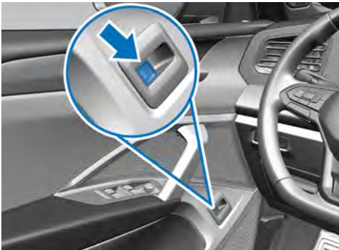
Taster in der Türverkleidung Fahrerseite
