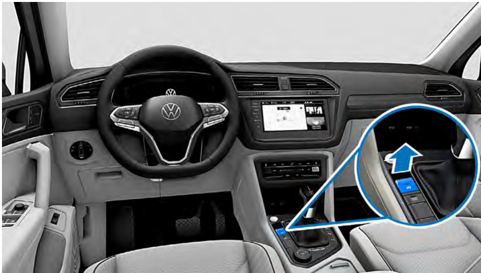
Konventionelles Fahrzeug mit Automatik-Getriebe: Elektrische Feststellbremse betätigen bzw. Handbremshebel ziehen.
