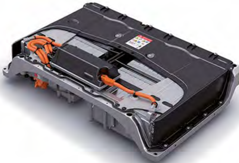
Die Hochvolt-Batterie des Passat GTE
