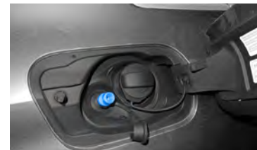
Flüssiggasanschluss am Tankeinfüllstutzen
