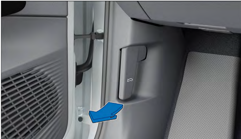
Im Fußraum auf der Fahrerseite: Entriegelungshebel für die Frontklappe (Beispiel ID.4).
