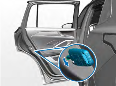
Kindersicherung mechanisch mit Schlüssel an der Tür deaktivieren
