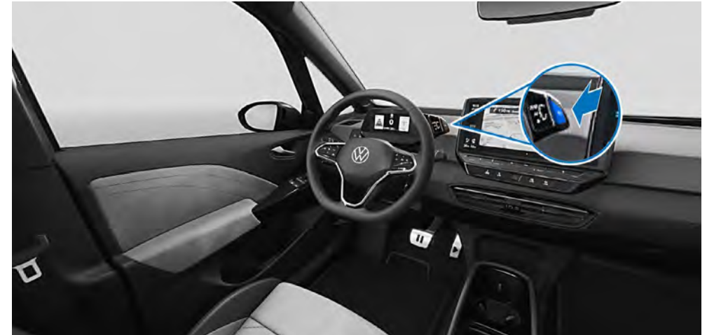
Elektrische Feststellbremse am rechten Lenkstockhebel betätigen.
