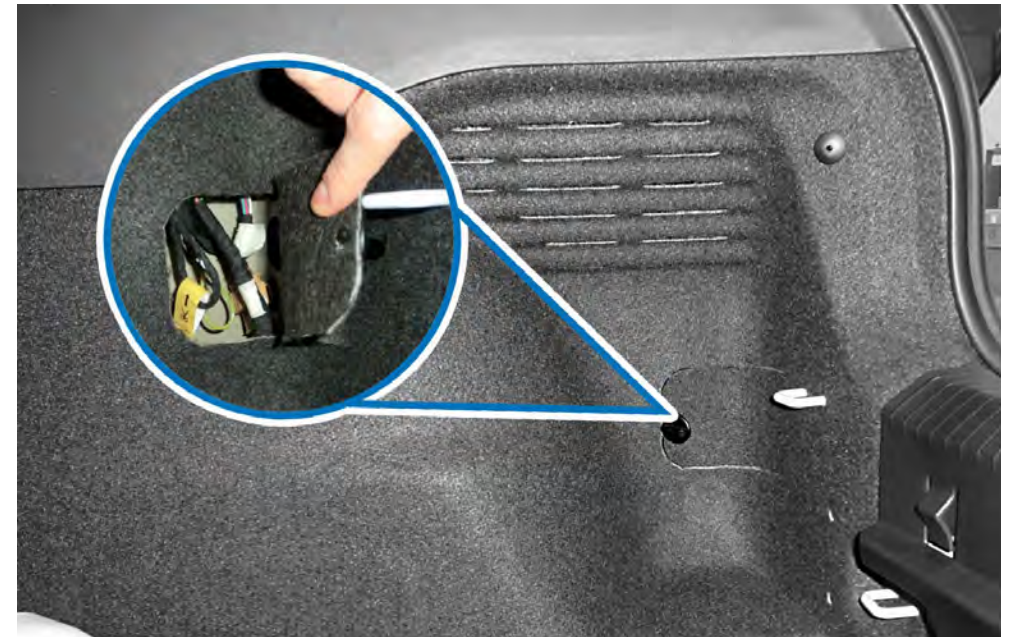
Variante 1: Trennstelle im Gepäckraum (Beispiel ID.3) hinter der Seitenwandverkleidung bis Ende 2020. Das gelbe Fähnchen kennzeichnet die Trennstelle.
