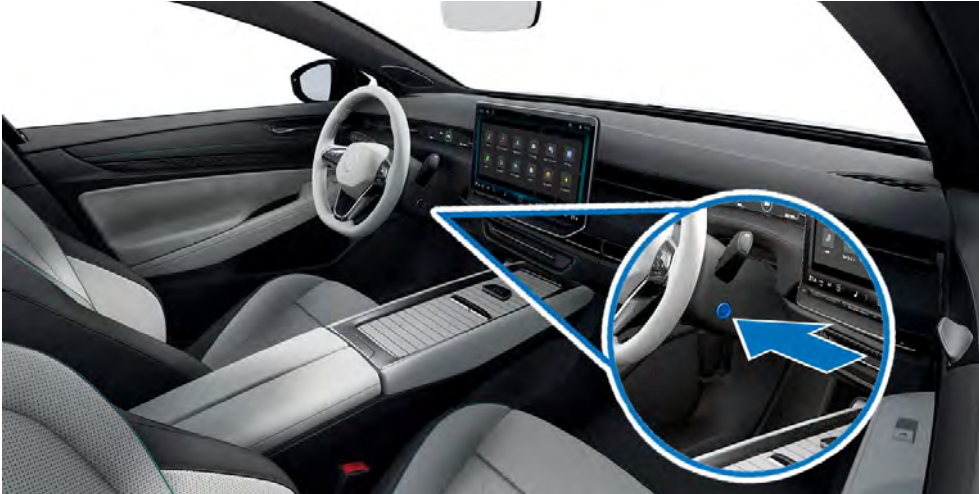
Vehículo con tecla "START-ENGINE-STOP" en la columna de dirección.
