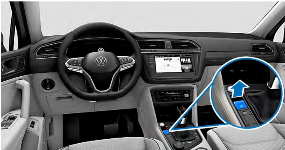
Vehículo convencional con cambio automático: accionar el freno de estacionamiento eléctrico o tirar de la palanca del freno de mano.
