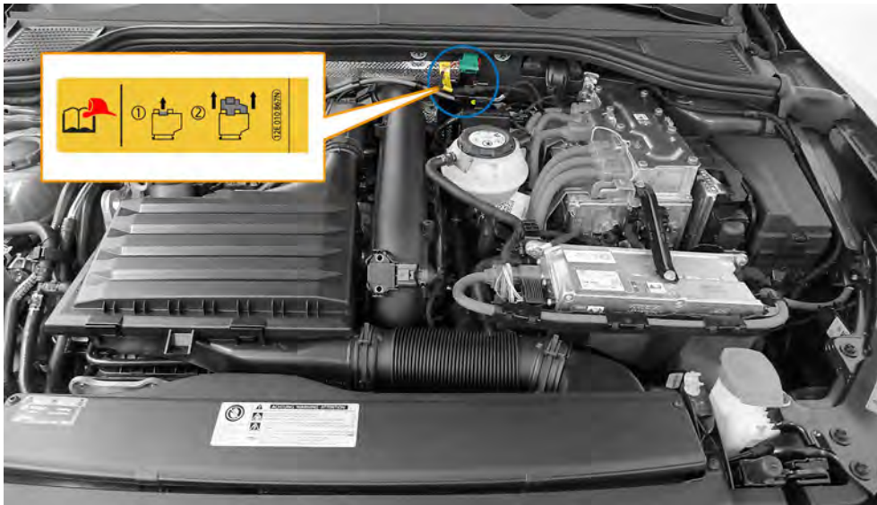
Punto de corte en la parte delantera del vehículo, vehículos híbridos (Golf GTE a partir de 2020), véase también Nueva señalización a partir del ID.7.
