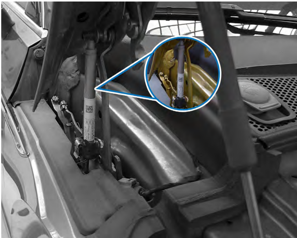
Ejemplo de capó activo con actuador pirotécnico.
