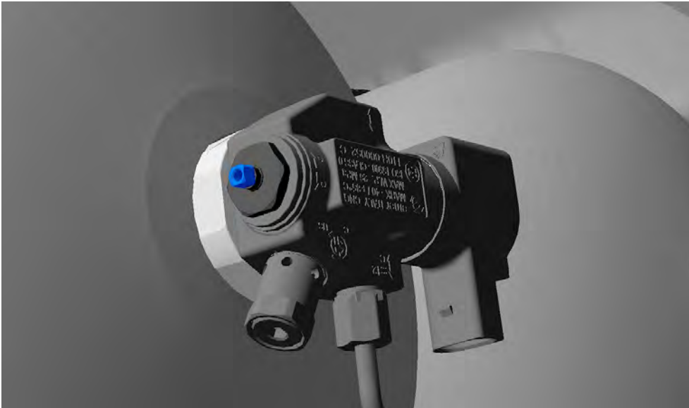
Girar la válvula de cierre hasta el tope en el sentido de las agujas del reloj con una llave de boca del 5, unos alicates o una herramienta especial.
