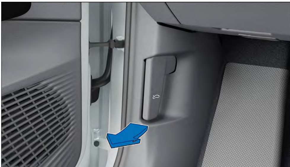
En la zona reposapiés del lado del conductor: palanca de desbloqueo del capó delantero (ejemplo ID.4).
