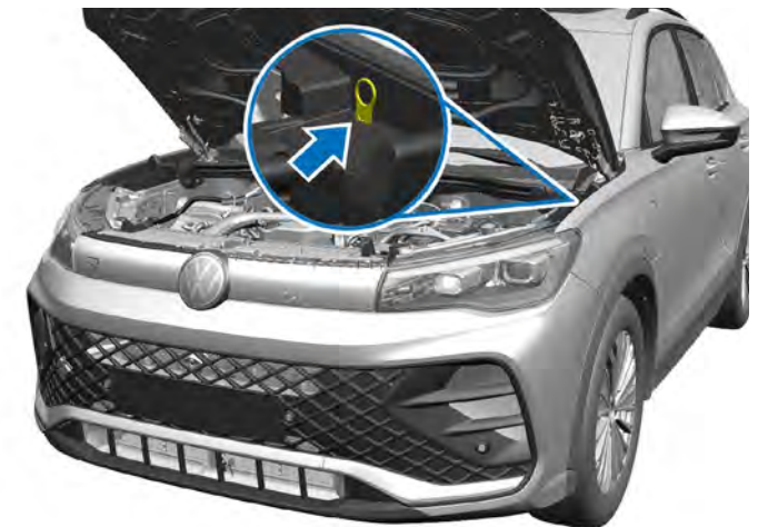
Ejemplos de ubicaciones del bloqueo de emergencia de la estación de carga.
