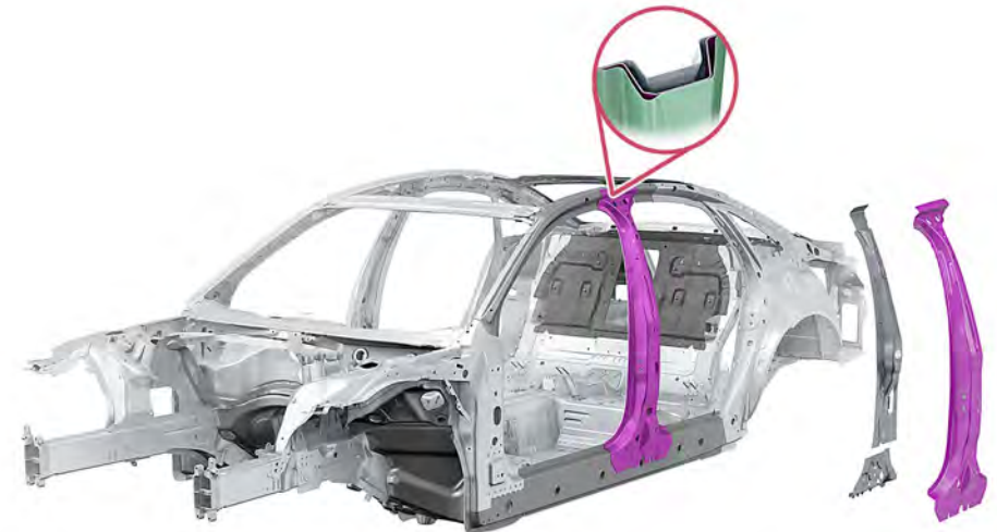
Pilar B con estructura multicapa
