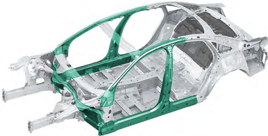
Carrocería con celda para los ocupantes reforzada
