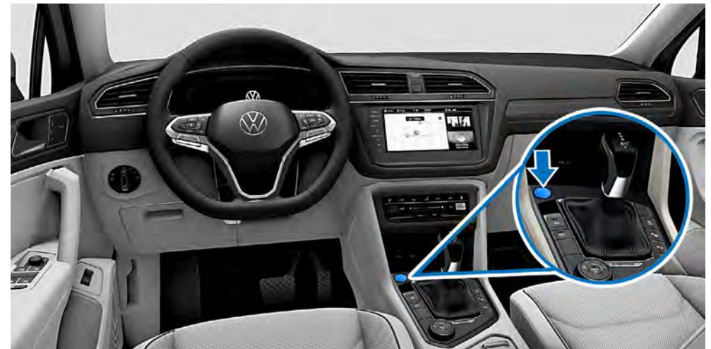
Vehículo con tecla "START-ENGINE-STOP" en la consola central.
